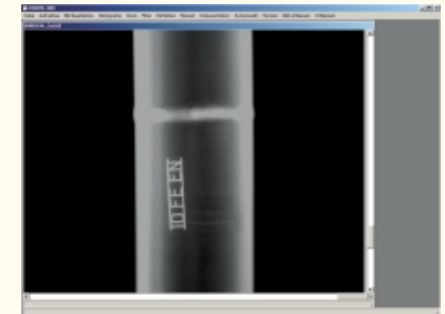
Abb. oben: Schweißnaht mit EN-Drahtsteg
